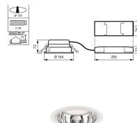
**Caractéristiques Philips Spot encastrable LED LuxSpace Mini DN560B 9W 1350lm 80D - 830 | 164mm - Aluminium Réflecteur - Éclairage de secours 3 heures**
