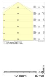
**Caractéristiques Ledvance Étanche Réglette Imperméable High Efficiency PC Gris 29W 4640lm - 840 Blanc Froid | 120cm - Dali Dimmable-Remplacement 2x36W**
