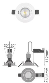
**Technische Daten Ledvance LED-Spot Kit schwenkbar GU10 PAR16 8.3W 520lm 36D - 930 | Höchste Farbwiedergabe - Dimmbar - Ersatz für 65W**
